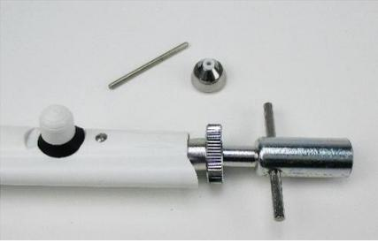
Die Montage der Spannzange erfolgt in umgekehrter Reihenfolge. Achten Sie darauf, dass die Spannzange bei der Montage geöffnet ist (Knopf nach vorne schieben) und richtig angezogen wird.
